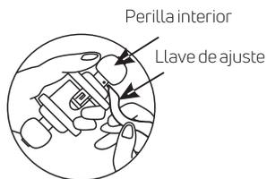
2.2 Retire la canopla o escudo interior e introduzca la cerradura en el agujero de 54mm cuidando que el traccionador de la cerradura y la lengüeta del picaporte coincidan, giramos la perilla exterior para verificar el buen funcionamiento del picaporte y atornillamos.
